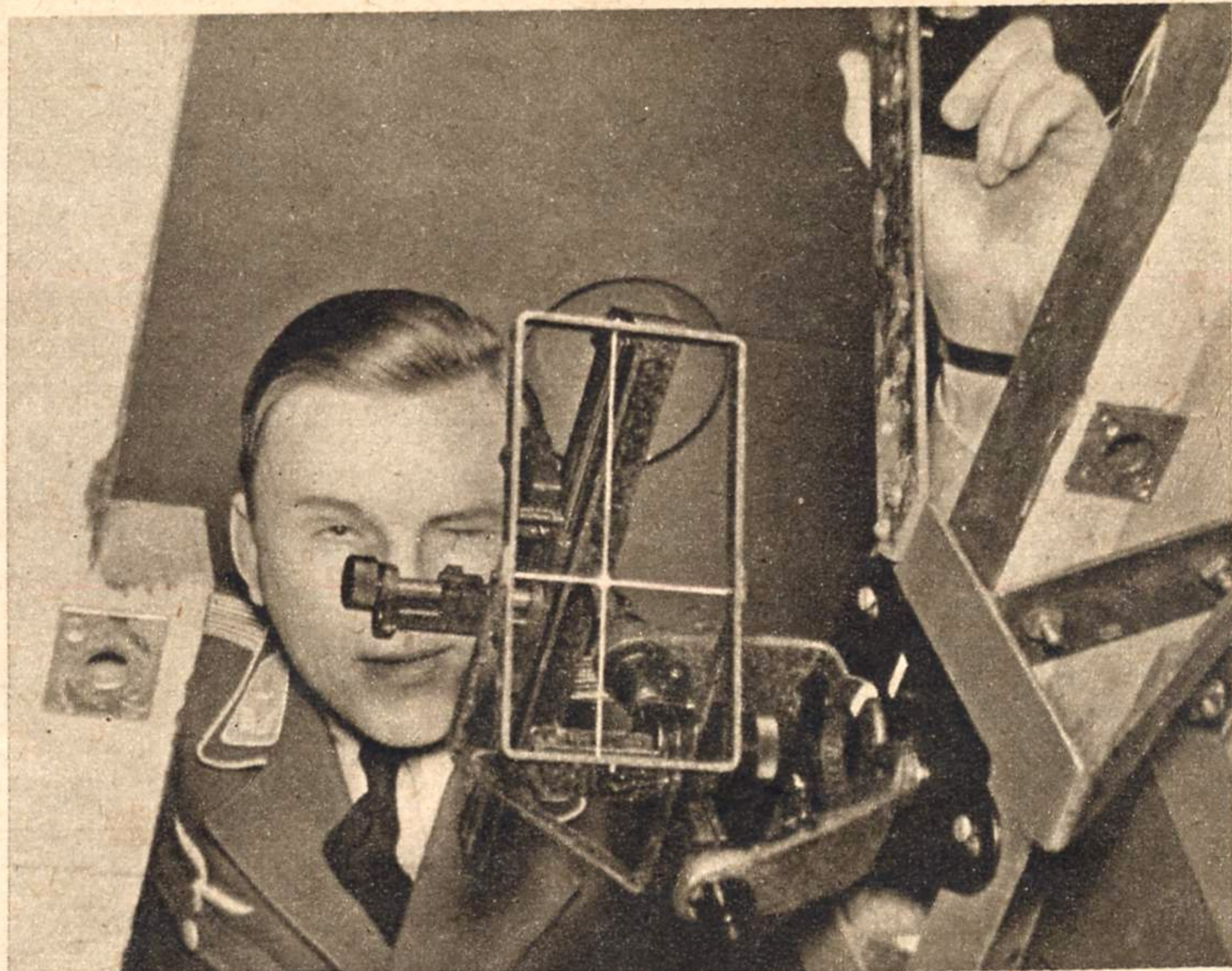
Während der Ausbildung wird der Bombenabwurf immer wieder geprobt, bis er völlig „sitzt“. Hier die Arbeit am einfachen mechanischen Bombenzielgerät. Die Auslösung der Bombe erfolgt von Hand
